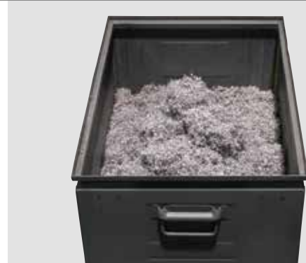
Vergleich Spänevolumen: Das Spanvolumen reduziert sich je nach Spanform und Material unterschiedlich stark. Bei Gussspänen wird eine Volumenreduzierung auf ca. 1:5 erreicht, bei Lang-Drehspänen aus Stahl wird eine Reduzierung auf ca. 1:50 erreicht.
