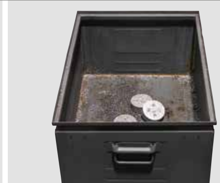
Vergleich Spänevolumen: Das Spanvolumen reduziert sich je nach Spanform und Material unterschiedlich stark. Bei Gussspänen wird eine Volumenreduzierung auf ca. 1:5 erreicht, bei Lang-Drehspänen aus Stahl wird eine Reduzierung auf ca. 1:50 erreicht.
