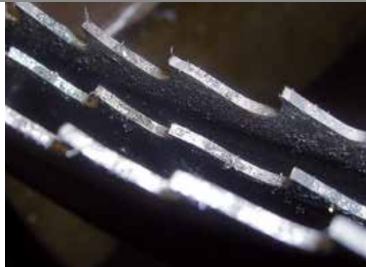
Spänehaftung im Zahngrund
